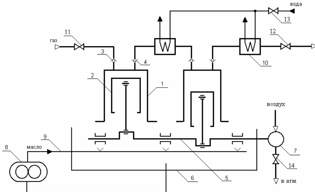
Рис. 1. Двухступенчатый поршневой компрессорный агрегат
