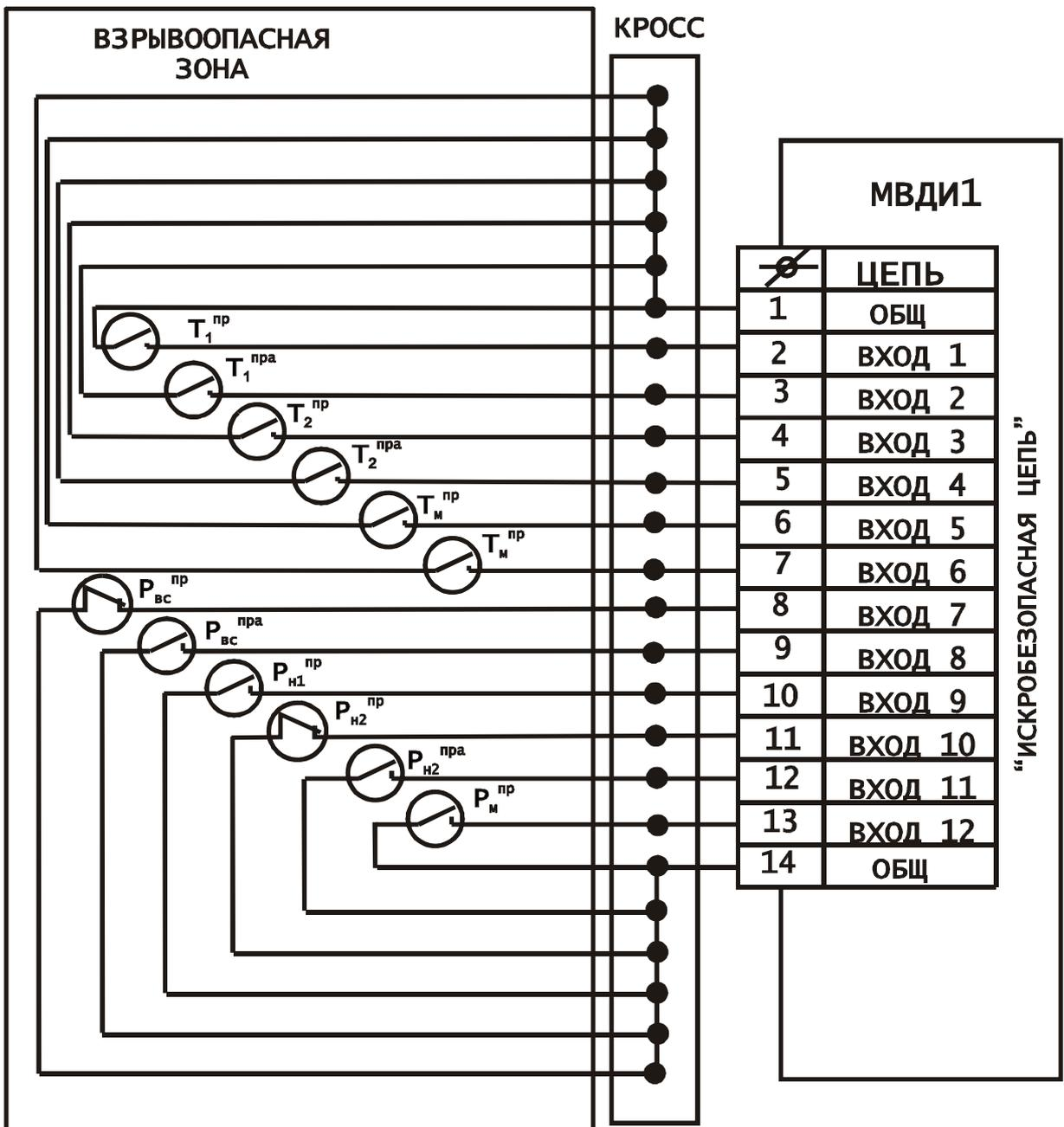
Рис. 5. Схема внешних соединений модуля МВДИ1
