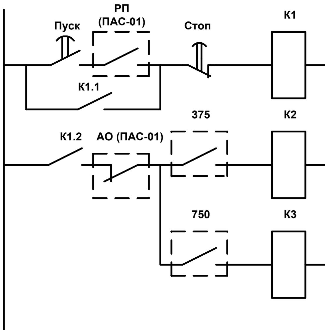
Рис. 19. Схема управления компрессором
