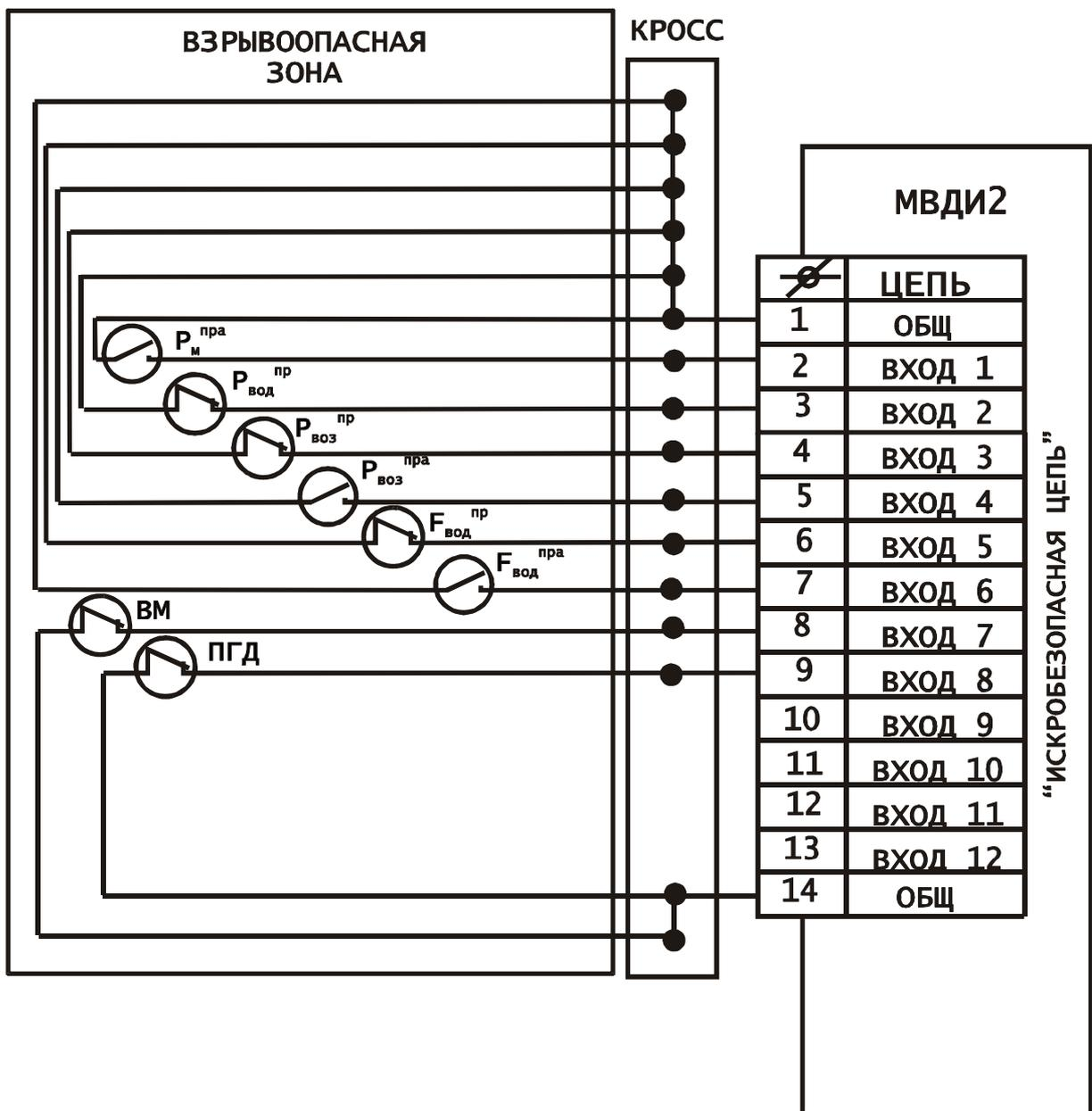
Рис. 6. Схема внешних соединений модуля МВДИ2
