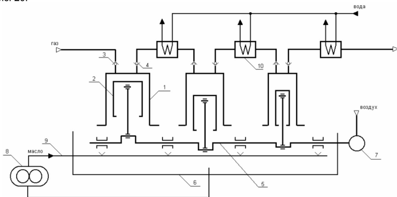
Рис. 20. Трехступенчатый поршневой компрессор
