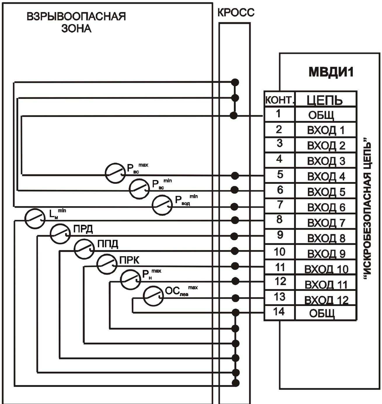
Рис. 23 Схема внешних соединений модуля МВДИ1
