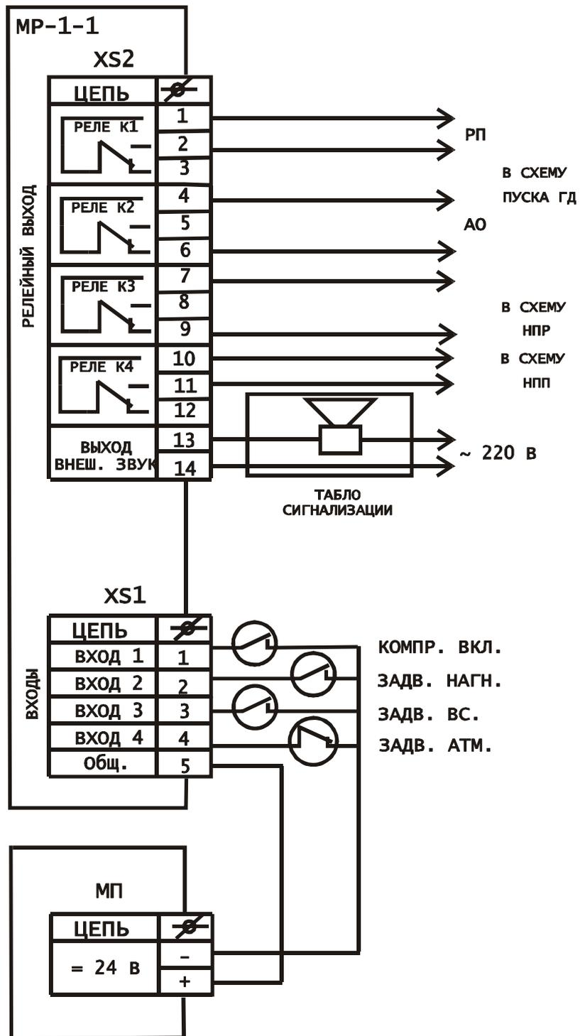
Рис. 7. Схема внешних соединений модуля MP-1-1
