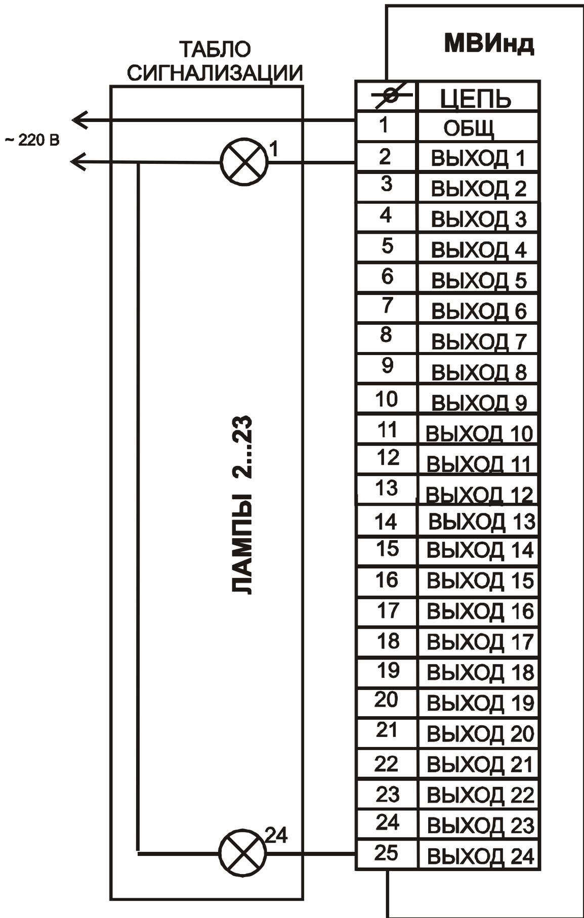
Рис. 9. Схема внешних соединений модуля МВИнд
